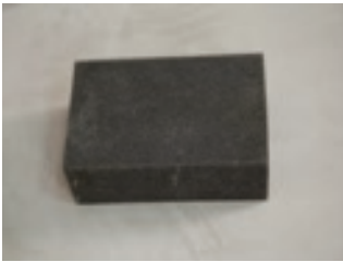
Une éponge de cimentier pour lisser les arêtes
